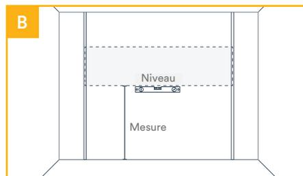
Mesurez à partir du sol. Marquez la hauteur souhaitée de la partie inférieure de la zone de panneaux SlatWall en traçant une ligne sur toute la largeur de l'installation à l'aide d'un niveau.
