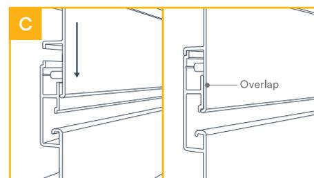
Raccordez solidement les deux panneaux en appliquant une légère pression jusqu'à ce qu'un "déclat" soit ressenti et entendu. L'emboîtement correct des panneaux est illustré ci-dessus.
