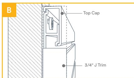
Coupez la Top Cap à la taille voulue. Placez la saillie arrière de la moulure dans la rainure du haut du panneau SlatWall, puis enclenchez la saillie inférieure sur le panneau. Les deux J Trims verticales doivent chevaucher la Top Cap aux deux extrémités.
