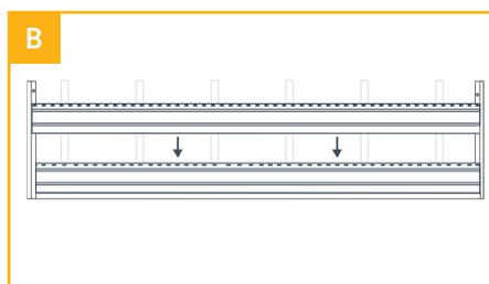
Insérez le panneau suivant dans les J Trim aux deux extrémités et faites-le glisser vers le bas jusqu'au panneau précédent.
