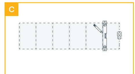
Pour les surfaces en cloison sèche, utilisez un détecteur de montants et un niveau pour localiser et marquer la longueur totale de chaque montant dans la zone d'installation en allant de haut en bas.
