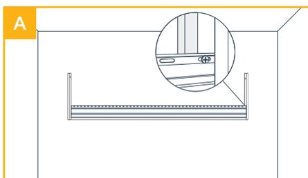
Insérez le premier panneau entre les J Trims verticales, et faites-le glisser vers le bas jusqu'à ce qu'il repose dans la J Trim du bas. Vissez à travers la bride jusque dans chaque montant en laissant un espace d'au moins 1/16 po sous les têtes de vis. Aux deux extrémités, vissez à travers les brides chevauchées.
