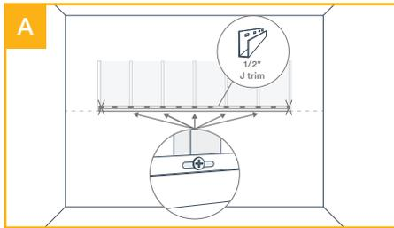
Au moyen de cisailles à tôles, coupez la moulure en 1/2" J Trim à la longueur horizontale. Alignez le bas de la moulure sur la marque de hauteur horizontale et fixez-la à chaque montant, à l'exception des montants aux deux extrémités.
