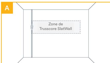
Chaque panneau doit commencer et finir sur un montant. Si la surface d'installation est une cloison sèche, localisez et marquez le premier et le dernier montant à l'aide d'un détecteur de montants.
